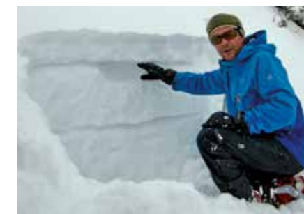
Bergführer Alexander Römer zeigt den Aufbau der verschiedenen Schneeschichten, die ausschlaggebend für die Lawinengefahr sind.
