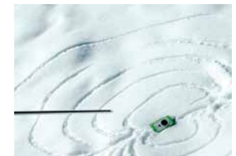
Eine Darstellung des Feldlinien-Verlaufs von LVS-Geräten. Besonders Neulinge sind dadurch schnell einmal verwirrt.
